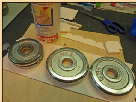
Bis zum Abbinden des Weissleims ist es manchmal sinnvoll die Pflasterplatten mit Gewichten zu beschweren.
